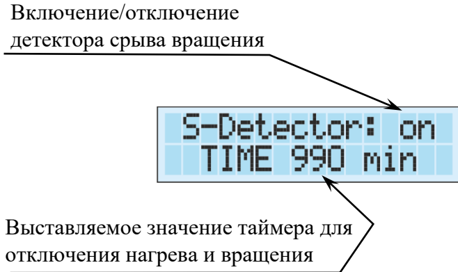
Рис. 10.4 Экран меню детектора срыва вращения и таймера
